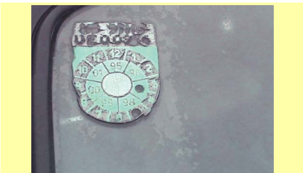
Abgelaufene und unkenntliche Prüfplakette
