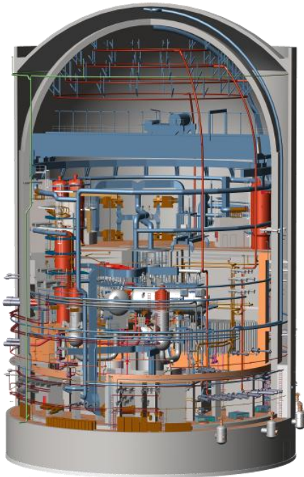
Abb. B.I.31: Schema eines Blocks mit einem Reaktor AES-2006 (Handelsbezeichnung MIR-1200)
