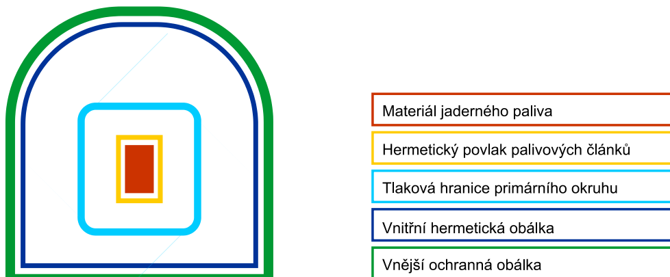
Abb. B.I.26: Physische Barrieren gegen einen Austritt radioaktiver Stoffe
