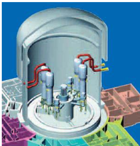
Bild Nr. 22 – Schematische Darstellung des Primärkreislaufes des Reaktors EPR1600
