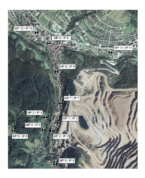
Generell zeigt sich eine durch den Baustellenbetrieb verursachte signifikante Änderung gegenüber dem Istzustand an den Immissionspunkten IP 1 – IP 6 durch den Baubetrieb auf der Baufläche sowie am Immissionspunkt IP 11 durch LKW-Fahrbewegungen im unmittelbaren Nahbereich sowie eine Überschreitung der Planungsrichtwerte laut Flächenwidmung, u.a. durch den Baulärm, an den Punkten IP 3 und IP 4 (durch Lärm von der Baufläche) und IP 11 (unmittelbare LKW Vorbeifahrten).
