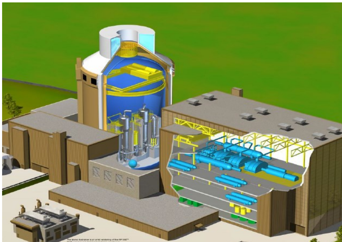
ABBILDUNG 2.3-4: AUFBAU DES AP-1000
