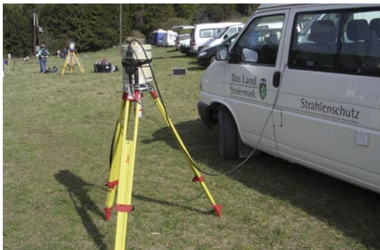
Abbildung 1: Gamma-Spektroskopiesystem zur Messung der radioaktiven Kontamination von Wald-, Flur- und Wiesenflächen.
