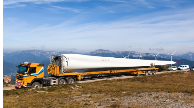
Der Rotor einer Windkraftanlage wiegt rund 20 Tonnen © Bernhard Strachwitz
