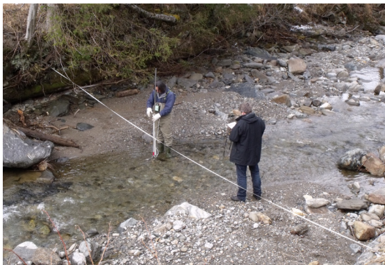
Abb 20 - Restwasserermittlung mittels Flügelmessung (Quelle: Land Steiermark, FA17C - Gewässeraufsicht)
