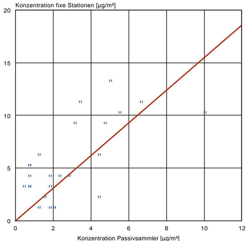
**Abbildung 8: Stickstoffdioxid Gegenüberstellung der Messwerte von Passivsammlern und kontinuierlich messenden Geräten**
