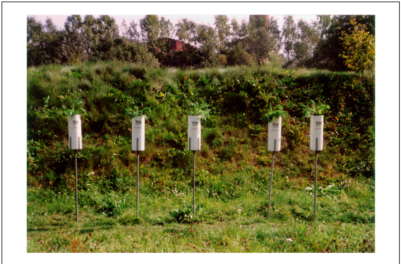
Abbildung 1: Grünkohlverfahren - Expositionseinrichtung mit Grünkohl ( Brassica oleracea 'Hammer') zur Ermittlung der Anreicherung von PAH, PCDD/F und PCB am Messpunkt 6 in Leoben
