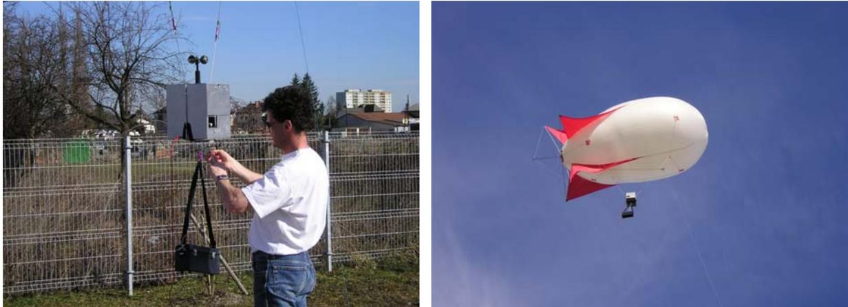
Abb. 2 u. 3: Meteorologische Sonde und mobiles Feinstaubmessgerät (links), Fesselballon mit Sonden (rechts)
