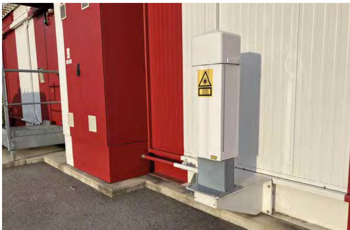
Foto 5.3: LIDAR, Laser-Wolkenhöhenmesser Vaisala CL31 der Austro Control GmbH am Standort Graz Flughafen. (Quelle: ACG)
