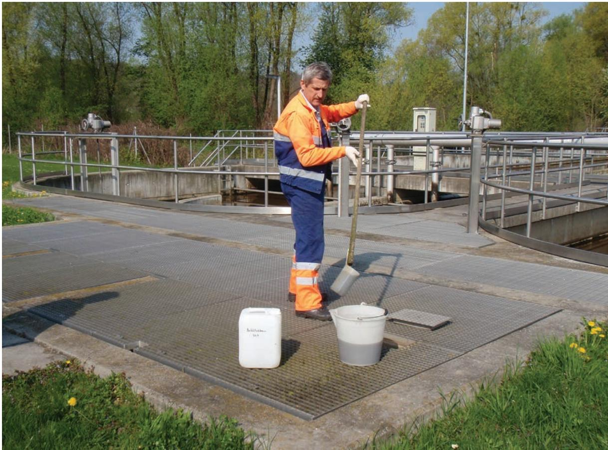
Probenahme des entwässerten Schlammes nach dem Dekanter
