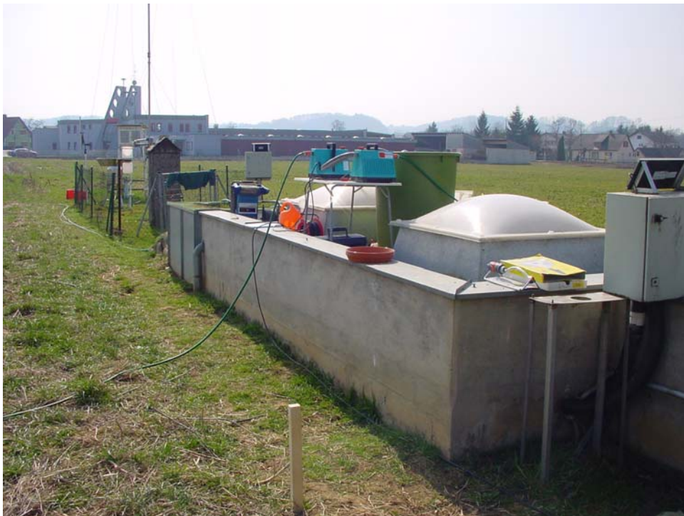
Foto 1: Aufbau der Versuchsanlage zur Beregnung des Deuteriums am 18.03.02 bei der Lysimeteranlage Wagna
