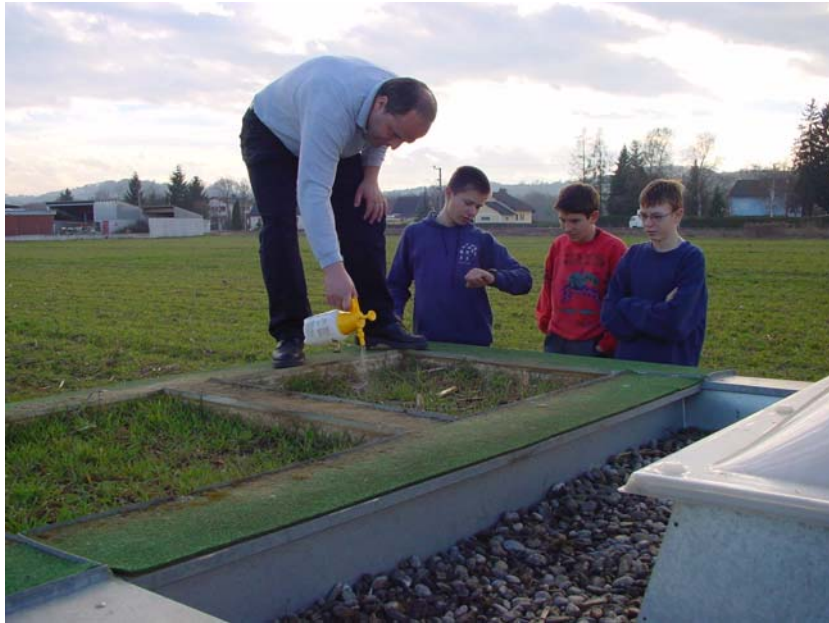
Foto 7: Aufbringung von Glyphosate in doppelter Konzentration auf dem rechten Gefäßlysimeter
