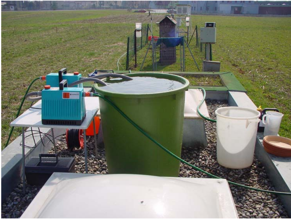
Foto 2: Vorbereitung des Tracers gelöst in 300 l Wasser für die Beregnung
