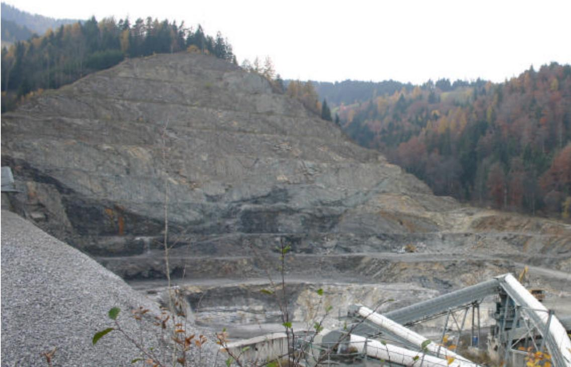
Abbildung 2: Tagebauendböschung im derzeitigen Abbaubereich
