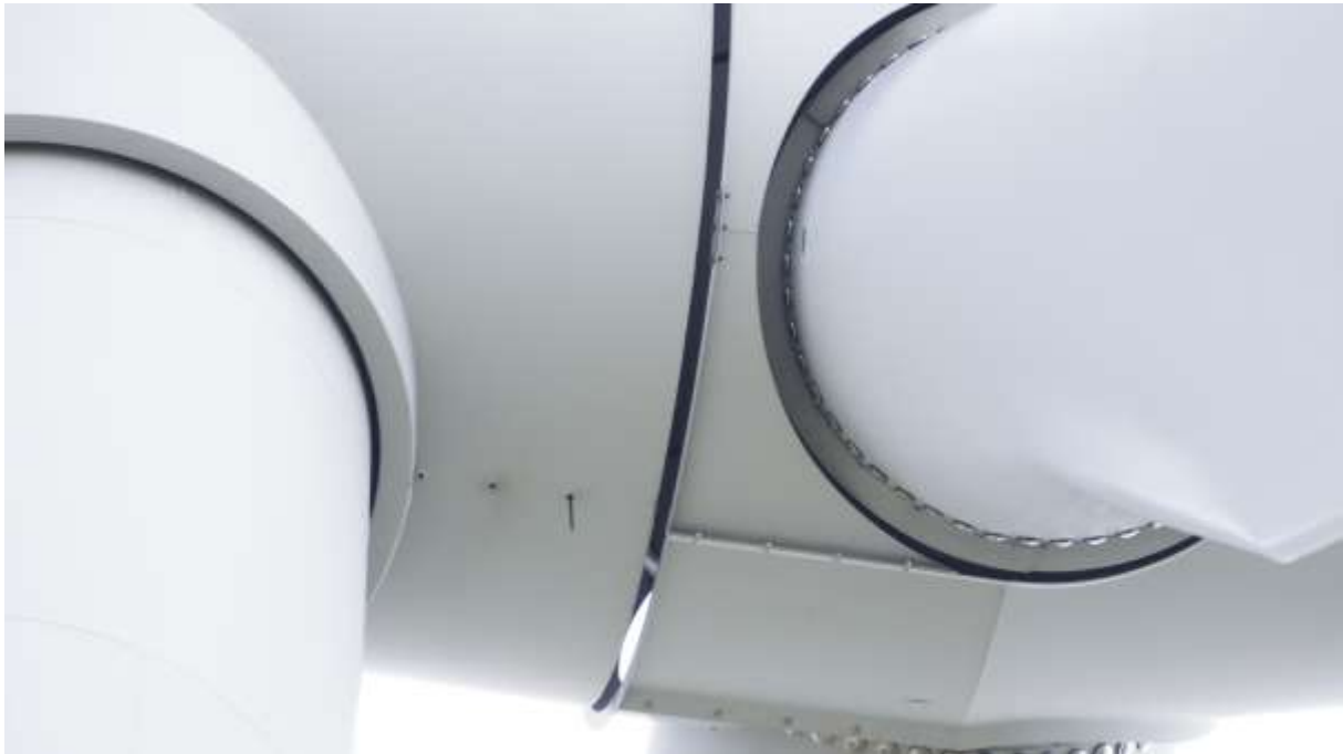
Abbildung 20 : Aus dem Gondelboden zwischen Turm und Rotor herausragender Mikrofonstab
