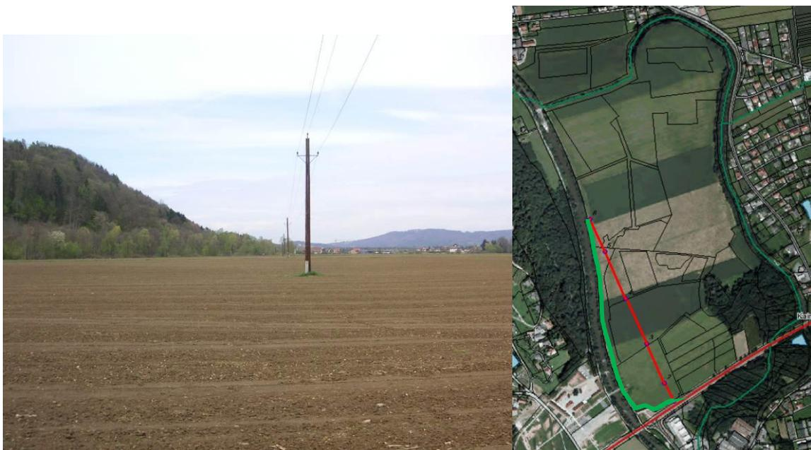
Abbildung 20: Verlauf der 20-kV-Stromleitung (rot - Bestand, grün - geplante Trasse)
