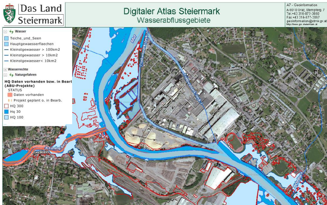
Abbildung 6: Wasserabflussgebiete im Projektbereich
