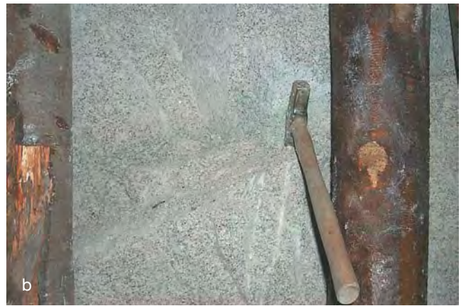
Abb. 83. Ehemaliger Untertagebergbau Kriechbaum: a) Abbauort b) Alterierter Mauthausener Granit mit kaolinisierten Feldspäten (Fotos: L. Weber).
