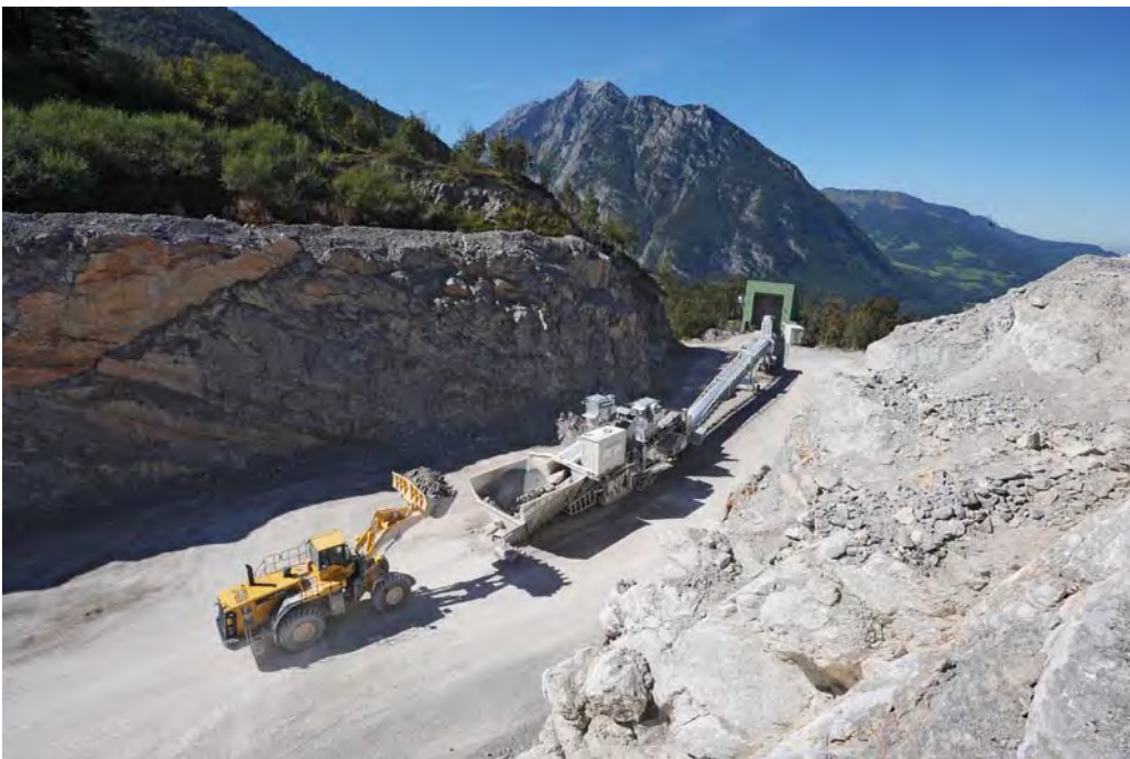
Abb. 92. Kalksteinabbau Ofenauer Berg: Mobilbrechanlage mit nachge- schalteten mobilen Förderbän- dern (Foto: Leube GmbH).
