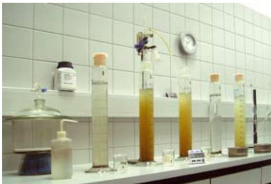
Abb 3: Standkolben für Korngrößenbestimmung. Die Korngrößenbestimmung erfolgt mit Sedimentation.
