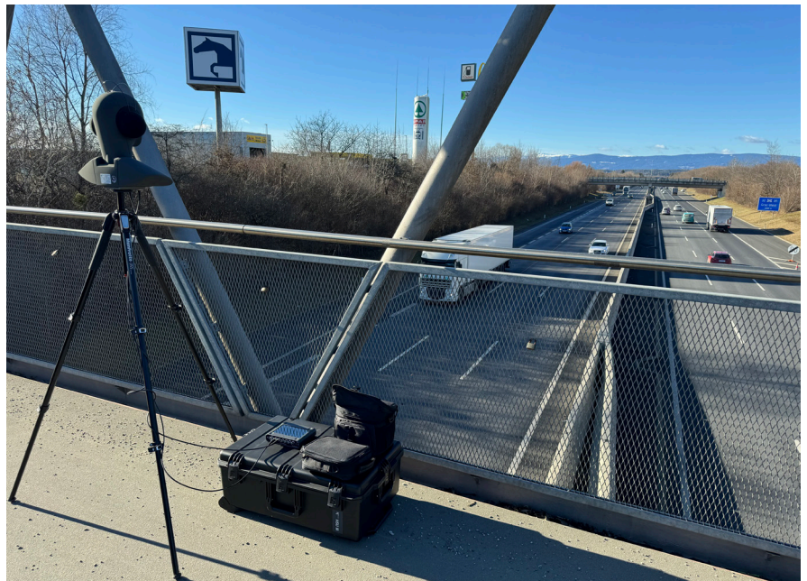
Binaurales Psychoakustik-Kunstkopf-Messsystem © ABT15, Referat Lärm- und Strahlenschutz
