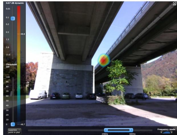
Messung eines Überfahrgeräusches an einem Brückenlager; © ABT 15
