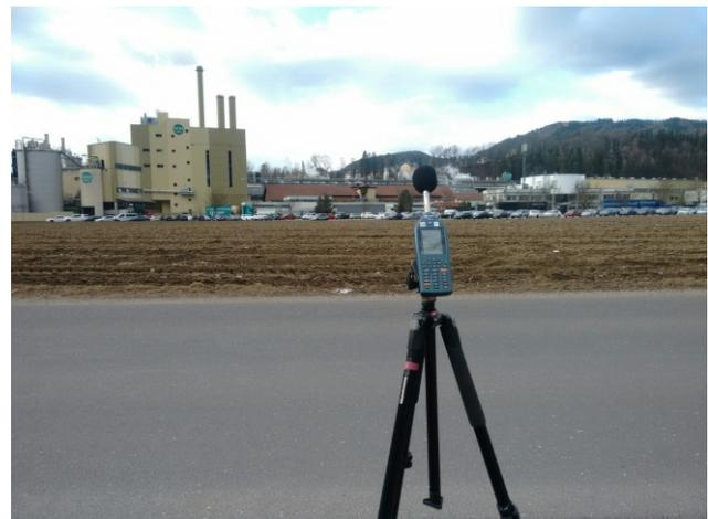
*Konventionelle Messung mit einem Schallpegelmesser, mit der nur die gesamte Emission der Industrieanlage erfasst werden kann, einzelne Schallquellen aber nicht lokalisiert werden können; © ABT 15*
