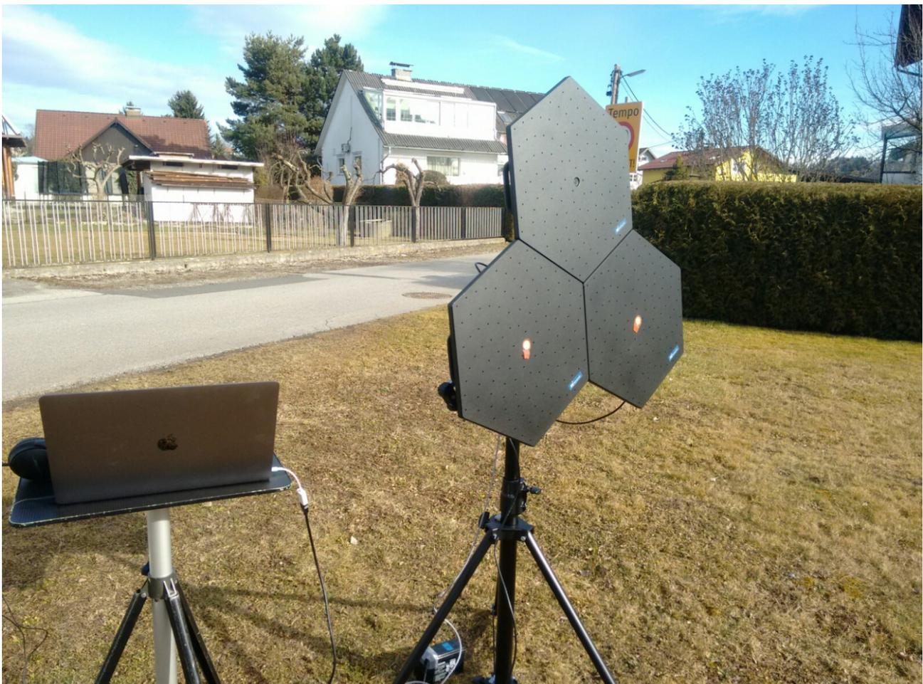
Akustische Kamera; Messsystem des Referates Lärm- und Strahlenschutz; © ABT 15
