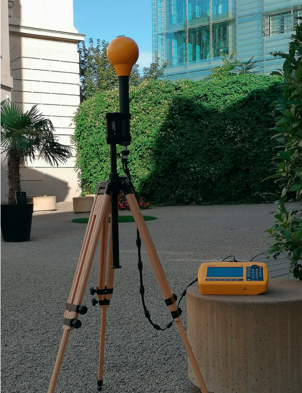
Frequenzselektive Messung hochfrequenter elektromagnetischer Felder, © Ewald Plantosar
