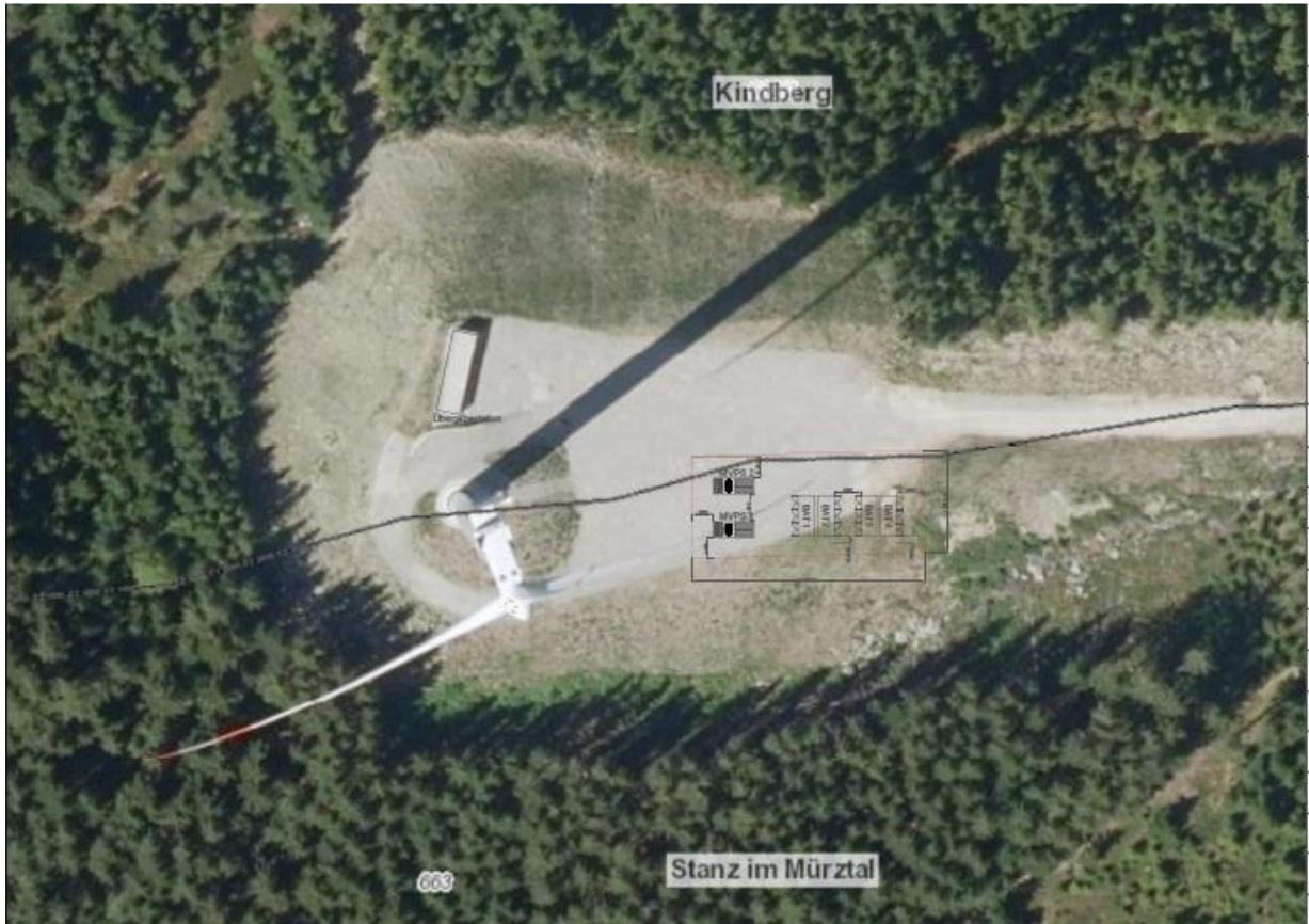
Abb.2 Ausschnitt Plan 2.01 Lage Batteriespeicher bei WEA 18 8
