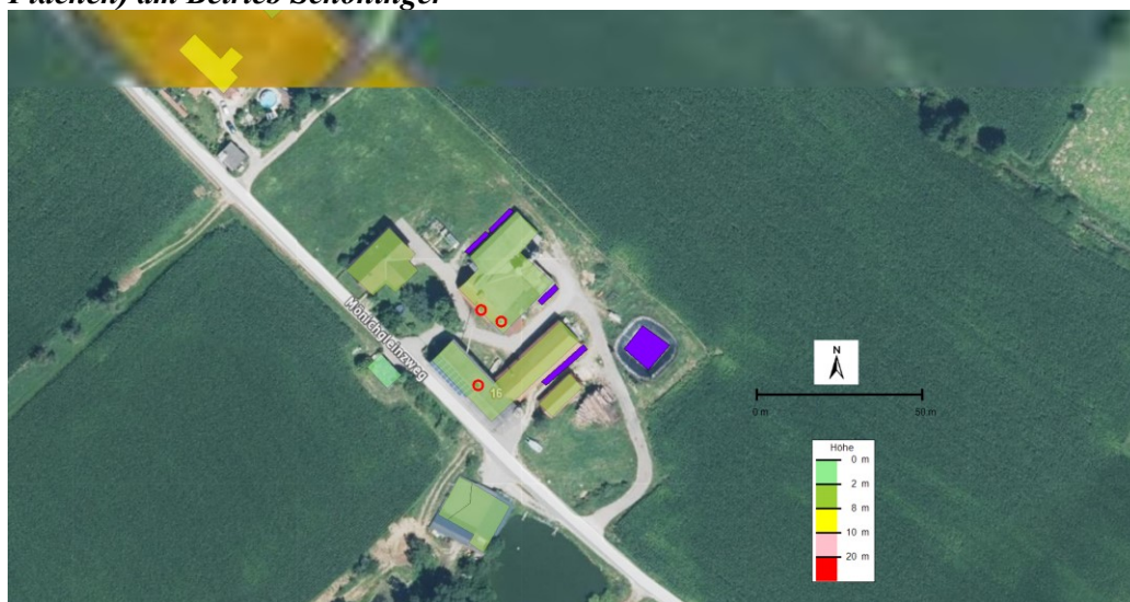
Abbildung 6: Lage und Höhe der Gebäude sowie Lage der Emissionsquellen (rote Kreise, violette Flächen) am Betrieb Schöninger
