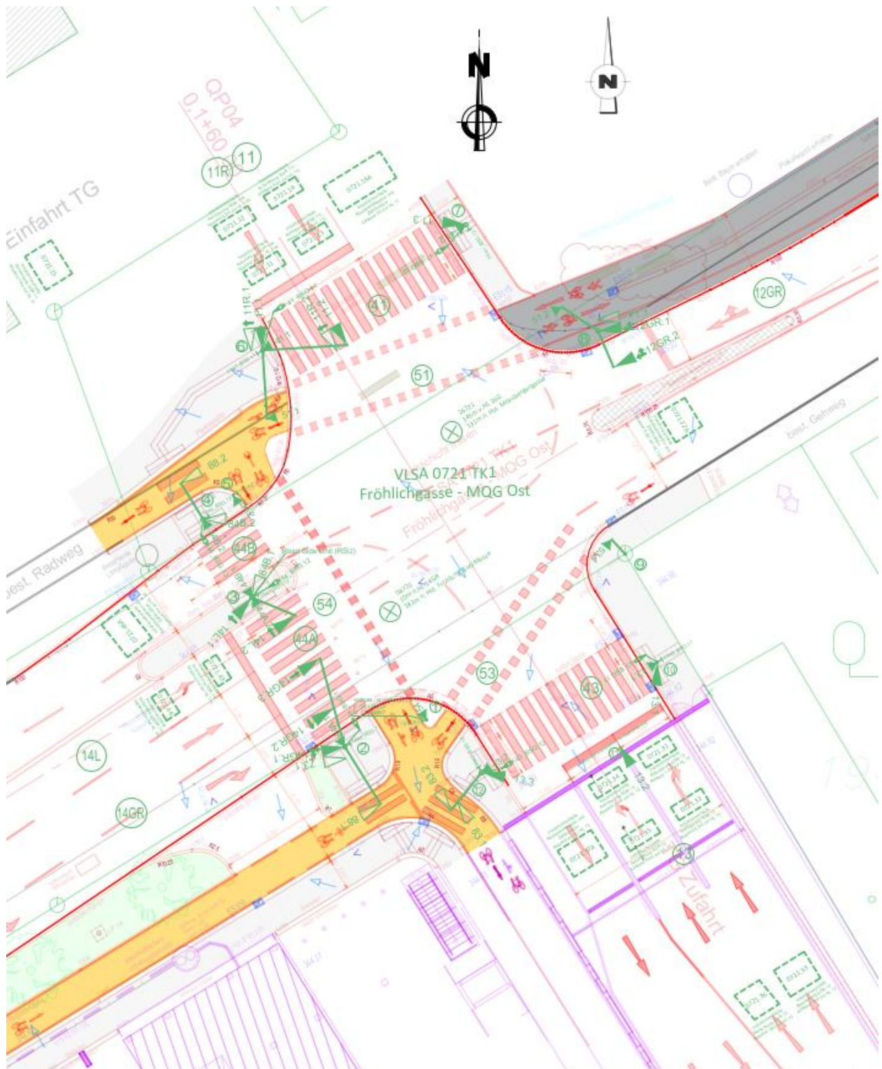
Abbildung 3-3: Signallageplan VLSA 0721 TK1 „Fröhlichgasse - MQG Ost“ (Quelle: PLANUM)
