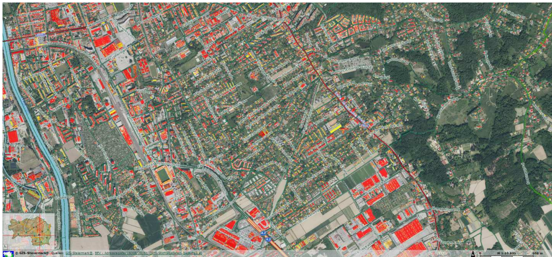
Abbildung 14: Auszug aus dem GIS-Solardachkataster - rot: sehr gut geeignet, gelb: gut geeignet (Quelle: GIS-Steiermark)
