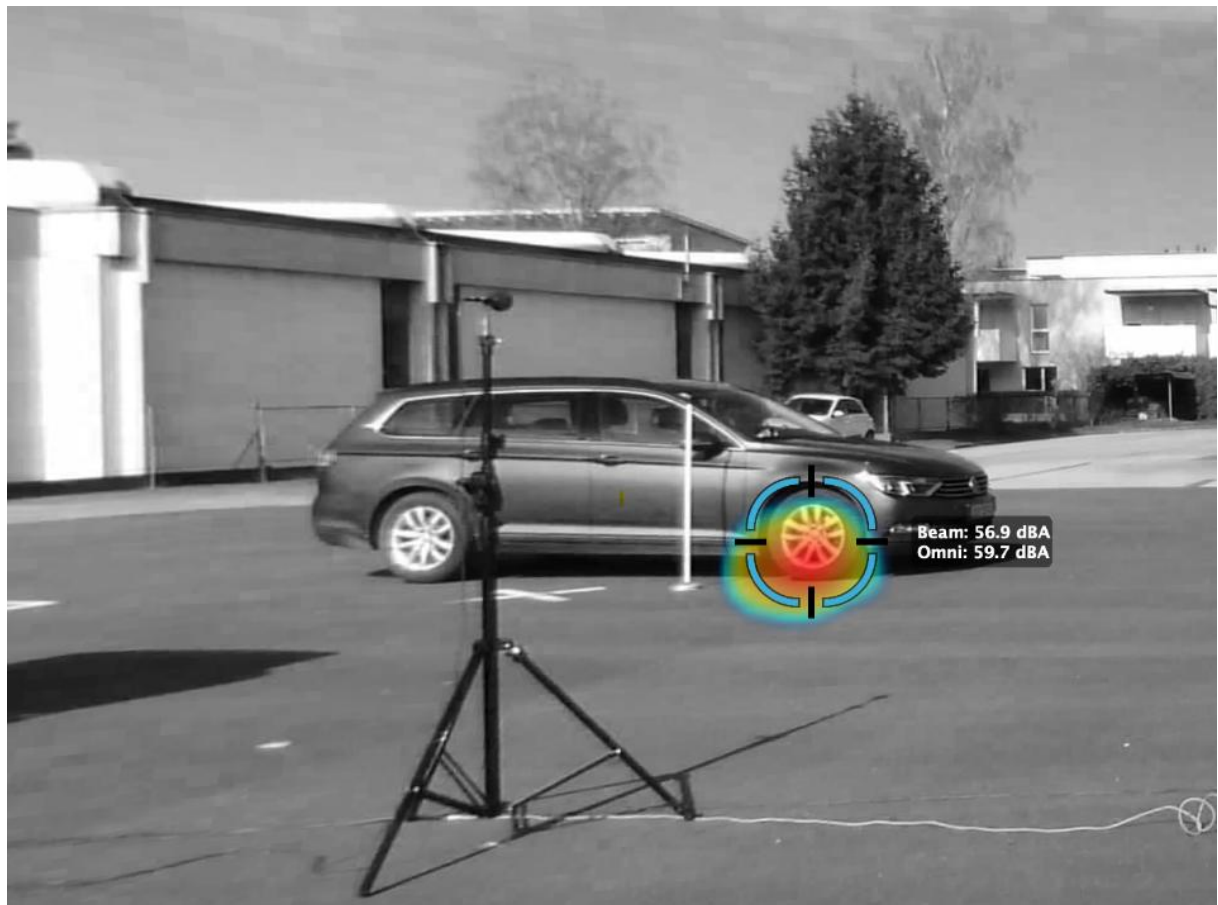
Abb. 1: Ausschnitt während einer beschleunigten Abfahrt mithilfe einer akustischen Kamera (Beifahrerseite)
