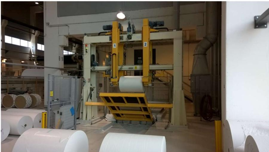
Die Rollenauffrennanlage wird für das Abwickeln von Ausschussrollen (Fehlrollen) verwendet.
