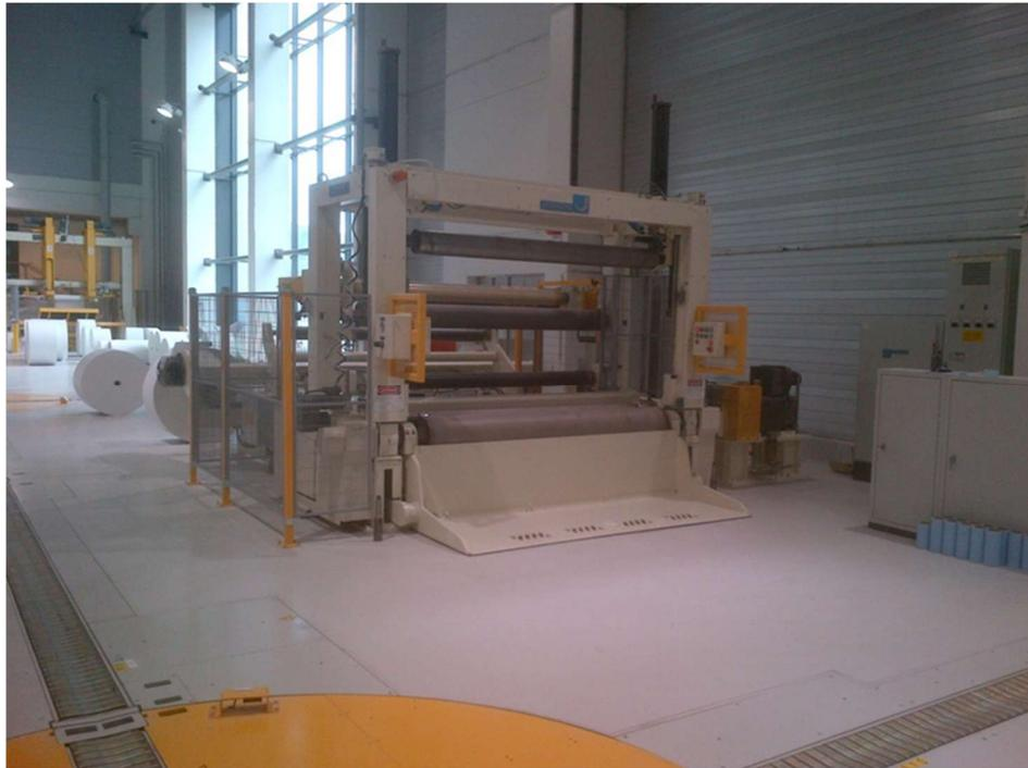
Dient zum Schneiden von Spezial Rollenformaten welche im Haupt Rollenschneider nicht produziert werden können, Weiterverarbeitung von Ausschußrollen und Fremdrollen.
