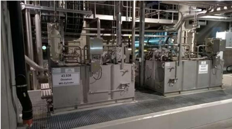
Die Ölumlaufschmieranlage dient zur Versorgung von ca. 200 Schmierstellen. Vorgesehen sind getrennte Ölkreisläufe für Nass- Trockenpartie und MG-Sektion.
