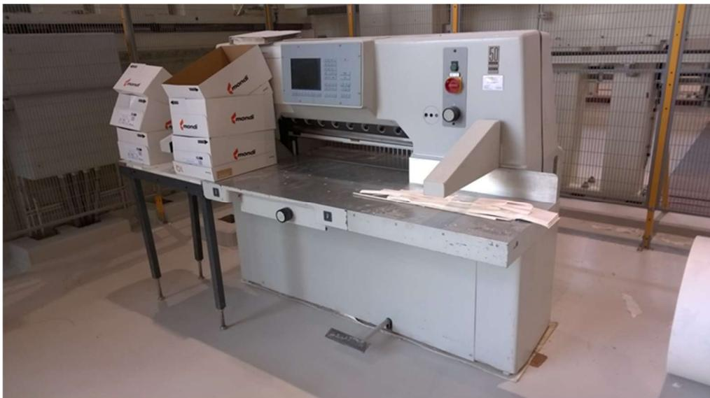
Der Planschneider dient zum Zuschneiden von Papierproben in ein definiertes notwendiges Maß. (A4/A5, Papierproben, Kundenmuster...)
