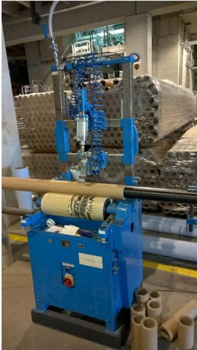
Dient zum halbautomatischen Ablängen von Kartonhülsen für den Doktorroller. Der Bediener legt eine Kartonhülse auf 2 Tragrollen zum Maßanschlag. Durch das Drücken der Zweihandsteuerung durch den Bediener senkt sich das Quetschmesser auf die Kartonhülse und trennt die Kartonhülse während des Drehens durch die Tragrollen.
